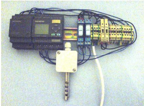
Gesteuert wird unsere Klimakammer mit dem Programm „LOGO“ und einem Temperaturfühler PT 100, der sich innerhalb der Klimakammer befindet. Der Rest der Steuerung befindet sich außerhalb des Kühlschranks.
