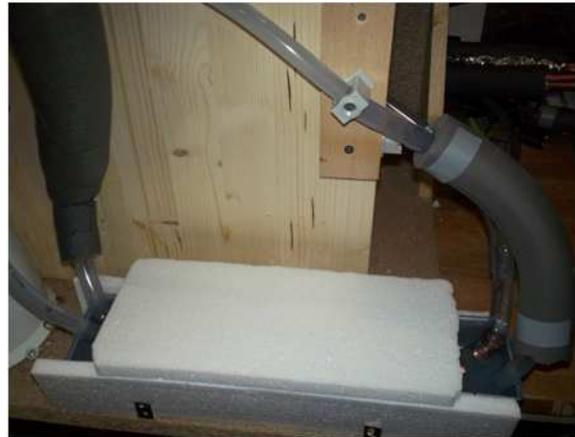
Abbildung 10: Kupferrohre in Kiste Wärmetauscher (mit Styropor gedämmt)
