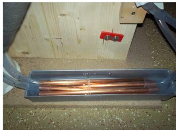
Abbildung 9: Kupferrohre in Kiste Wärmetauscher (ohne Dämmung)
