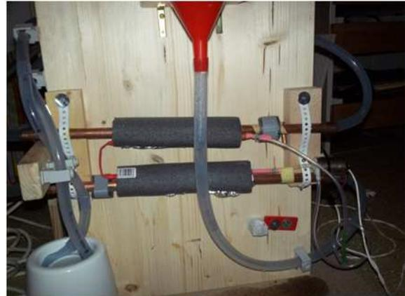
Abbildung 7: Wärmetauscher mit Pumpe und Kupferrohr
