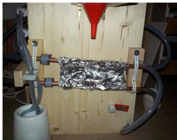
Abbildung 5: Alufolienwärmetauscher
