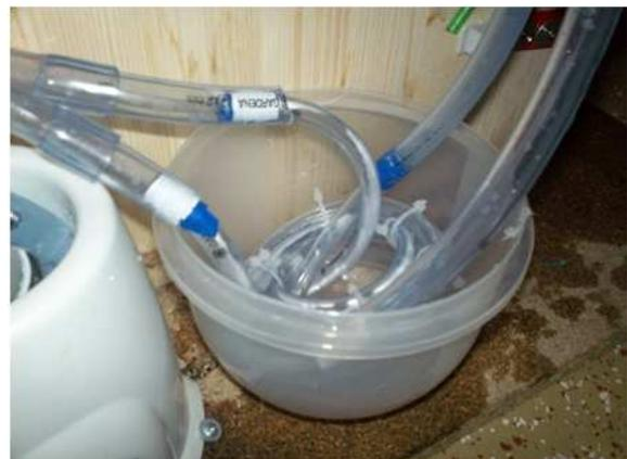
Abbildung 8: Spiralenwärmetauscher
